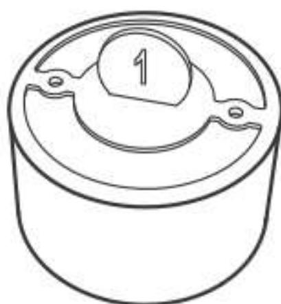
2、使用套筒配件，将传感器固定到天花板的圆形孔洞中。
